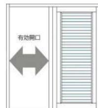
車椅子でも楽に走行できるように、段差が少ない下枠を採用しています。有効開口750mm以上が確保でき、融資基準に適合します。
